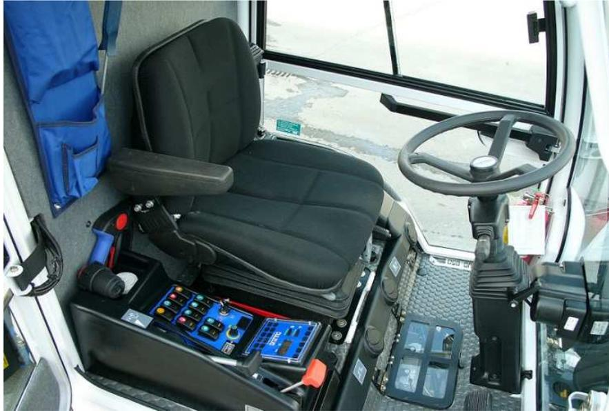
El confort del operador durante el invierno está garantizado por el sistema de calefacción de 3 velocidades, mientras que para el verano se cuenta con un sistema de aire acondicionado Delphi con mando de 3 velocidades y 4 bocas regulables para la salida del aire.
