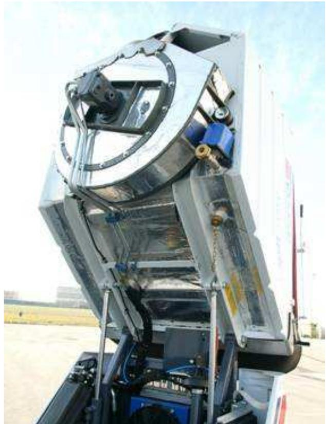
*Existe la opción de equipar la barredora con un tubo de aspiración que le permite recoger desechos difíciles de alcanzar con los cepillos.*
