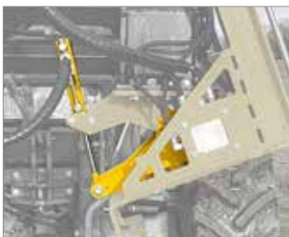
Vérin d'inclinaison pour attache Télescopique/Chargeur frontal (+/- 20°)
